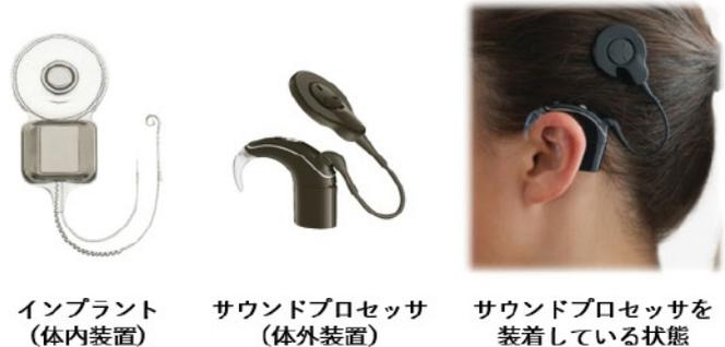
図1 人工内耳の装置
